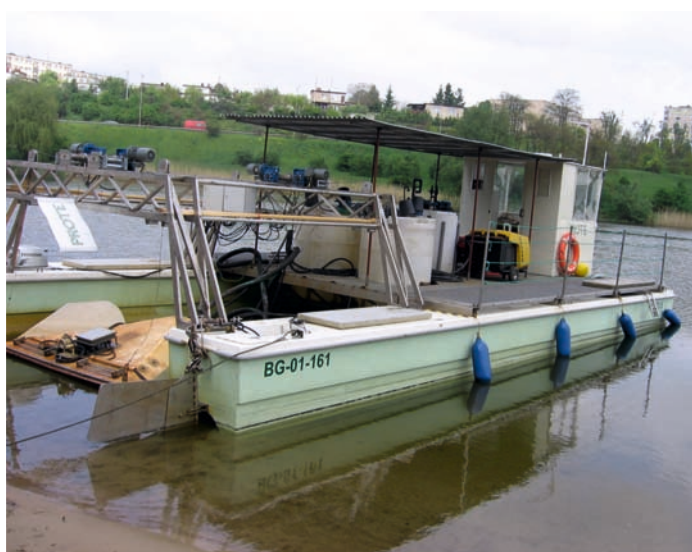
Jednostka pływająca na Jeziorze Winiary z widocznym modulem podwodnym zawieszonym w doku modułu nawodnego
