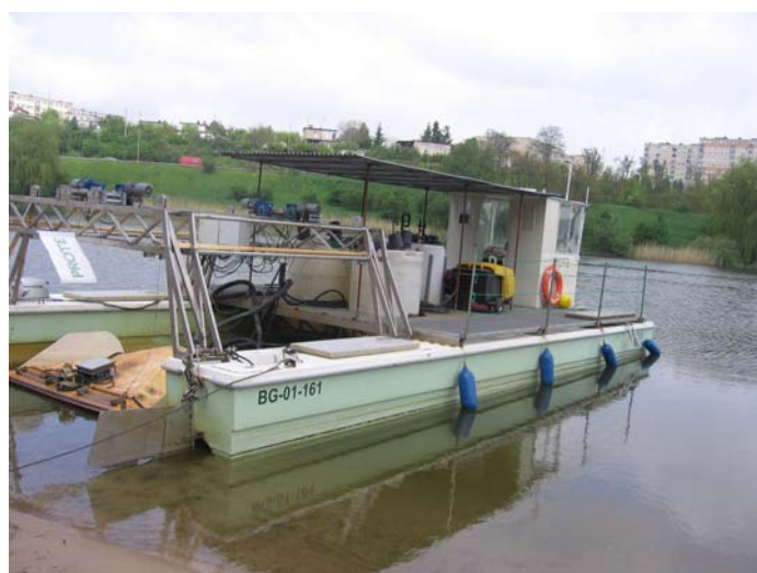
Jednostka pływająca na Jeziorze Winiary z widocznym modulem podwodnym zawieszonym w doku modułu nawodnego
